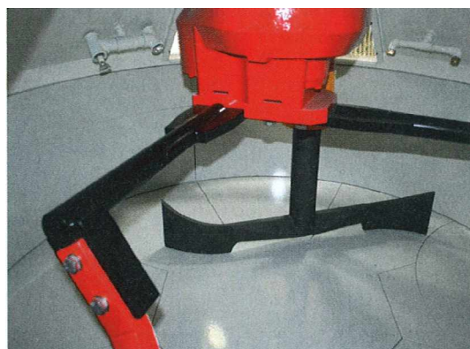
2. kép A teljes keverőszerszám bevonásra került a speciális réteggel
